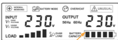
Batterieleiste mit Anzeige der Batteriekapazität
